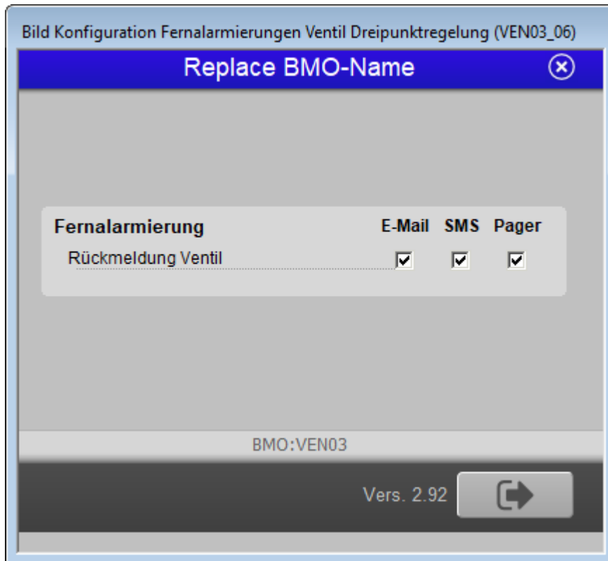
Bild der Fernalarmierung des stetigen Ventils mit Dreipunktregelung (VEN03)
