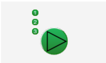
der dreistufige Motor (MOT03) besitzt für jede Stufe eine Rückmeldung
