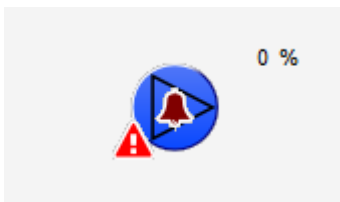
Motor MOT10 mit quittiertem Fehler
