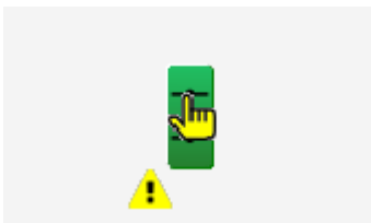
die Stellklappe (VEN02) wurde von Hand geöffnet
