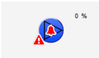
Motor MOT10 mit unquittiertem Fehler
