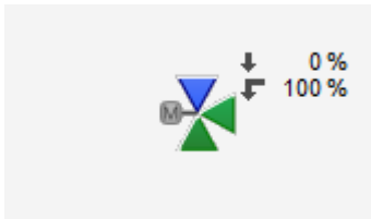
das stetige Ventil (VEN01) ist geschlossen
