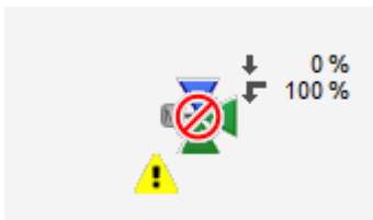
das stetige Ventil (VEN01) wird von Hand geschlossen
