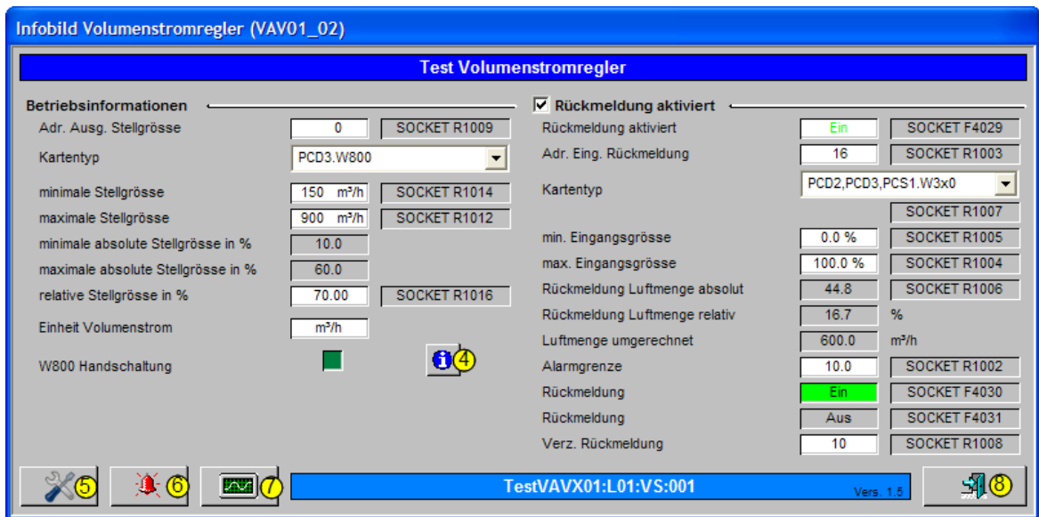
Infobild der Ansteuerung des variablen Volumenstromreglers (VAV01)
