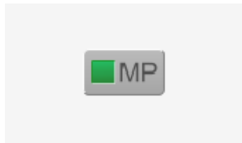
MP Master (MP_AMaster) ohne Störmeldung (im Normalbetrieb)
