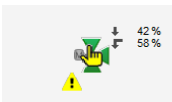
das stetige Ventil (VEN01) wird von Hand betrieben
