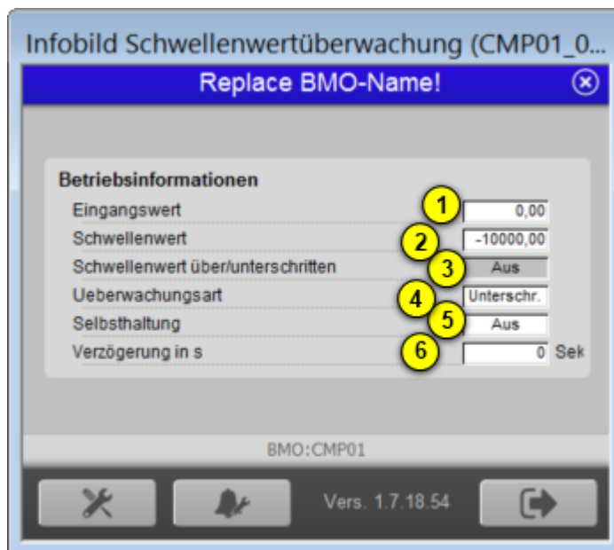
Infobild der Schwellenwertüberwachung (CMP01)
