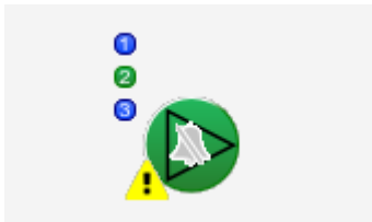
dreistufiger Motor (MOT03) mit einer Folgealarmunterdrückung
