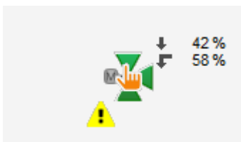
die Stellgröße des stetigen Ventils (VEN01) wird mit Hilfe der W800-Karte geschrieben
