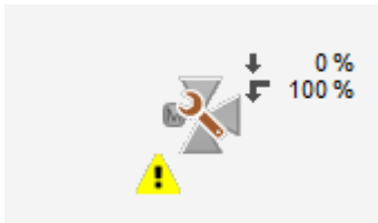
stetiges Ventil (VEN01) ist in Reparatur geschaltet
