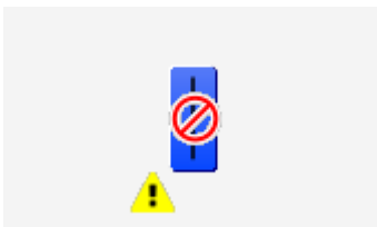
die Stellklappe (VEN02) wurde von Hand geschlossen
