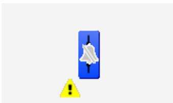
die Folgealarmunterdrückung der Stellklappe (VEN02) ist aktiviert
