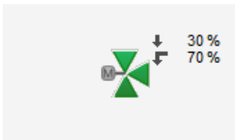
das stetige Ventil (VEN01) ist zu 30% geöffnet
