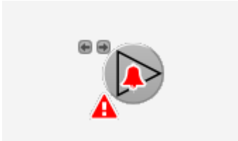
Motor mit Vor- und Rückwärtsbetrieb (MOT05) mit unquittierter Störmeldung
