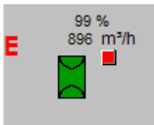
Ansteuerung des variablen Volumenstromreglers (VAV01) mit unquittiertem Fehler
