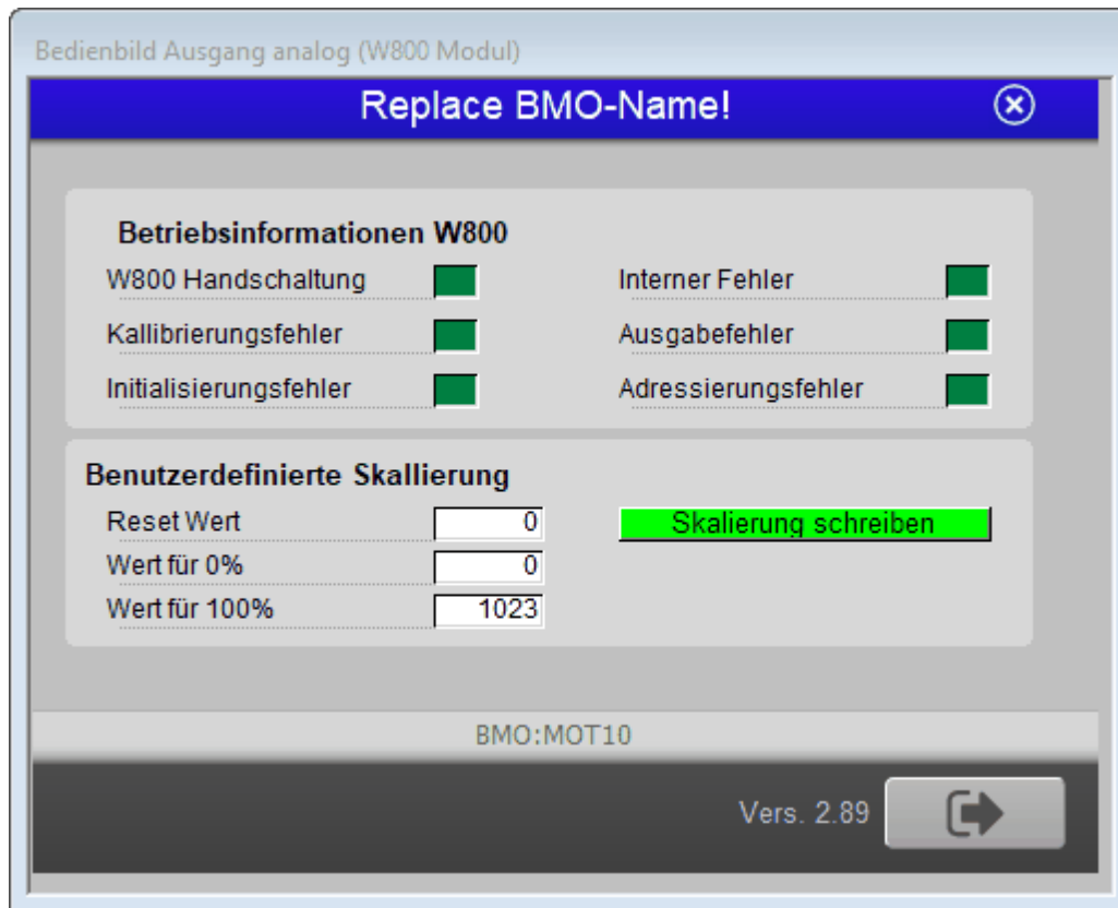
Anzeige, dass die neue Skalierung auf die W800-Karte geschrieben wird
