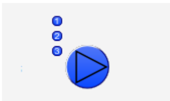
der dreistufigen Motor ist ausgeschaltet und besitzt keine Störmeldungen
