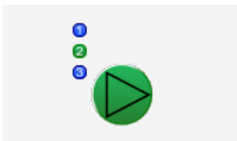
der dreistufige Motor (MOT03) wird in der zweiten Stufe betrieben
