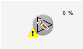
Motor MOT10 in Reparatur geschaltet
