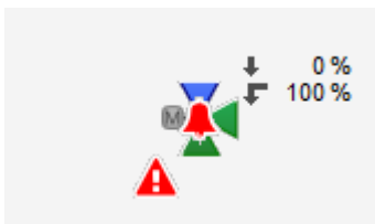
stetiges Ventil (VEN01) mit unquittierter Störmeldung
