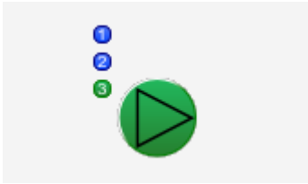
der dreistufige Motor (MOT03) wird in der dritte Stufe betrieben
