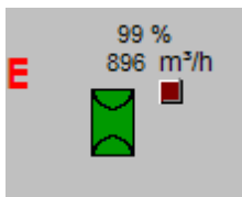
Ansteuerung des variablen Volumenstromreglers (VAV01) mit quittiertem Fehler
