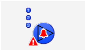
der dreistufige Motor (MOT03) besitzt eine unquitierte Störmeldung
