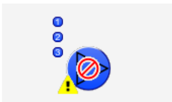
der dreistufige Motor (MOT03) wurde von Hand ausgeschaltet.
