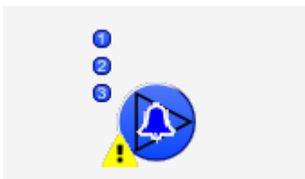
der dreistufige Motor (MOT03) besitzt eine gehende Störmeldung
