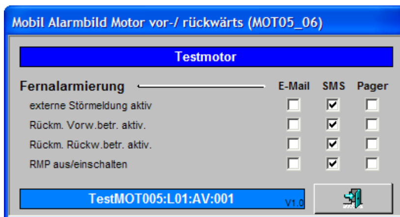
Konfiguration der Fernalarmierung per SMS am Beispiel eines Motors mit Vor- und Rückwärtsbetrieb (MOT05)
