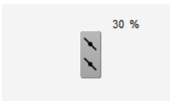
das stetige Ventil (VEN01) ist zu 30% geöffnet
