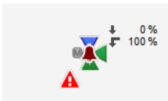
stetiges Ventil (VEN01) mit quittierter Störmeldung
