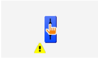
der Ausgang der Stellklappe (VEN02) wurde mittels einer A810-Handschtaltung übersteuert
