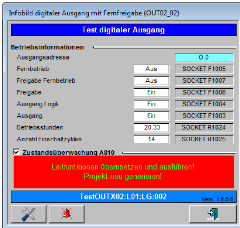
nicht identische Ausgangsadressen "Ausg" und "Ein_Ausg_A810" des digitalen Ausgangs mit Fernfreigabe (OUT02)
