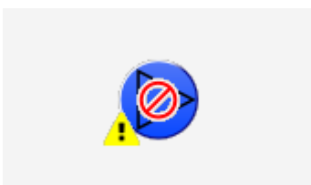
der Motor (MOT01) wurde von Hand ausgeschaltet
