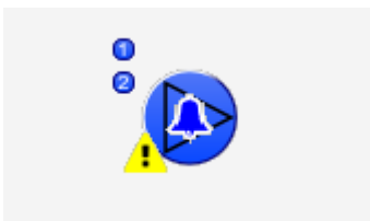
der zweistufige Motor (MOT02) besitzt eine gehende Störmeldung
