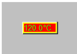
Ersatzwert einer Temperaturmessung (MES01), welcher sich nicht innerhalb einer gegebenen Limite befindet
