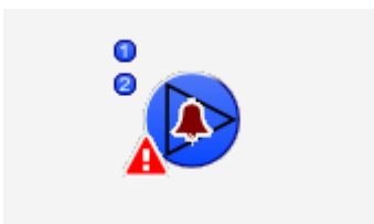
der zweistufige Motor (MOT02) besitzt eine quittierte Störmeldung
