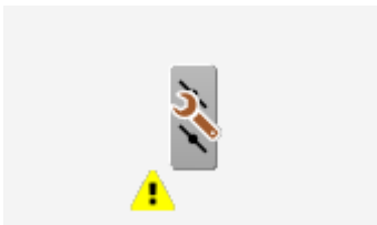
die Stellklappe (VEN02) wurde in Reparatur geschaltet
