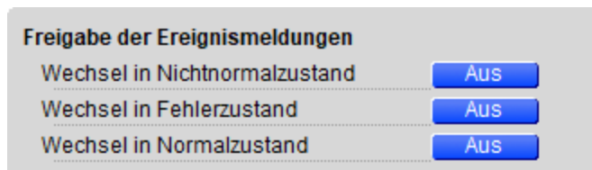
Konfiguration der Ereignisse und Störmeldungen des Alarmbilds der Wochenschaltuhr (Bac_schedule)
