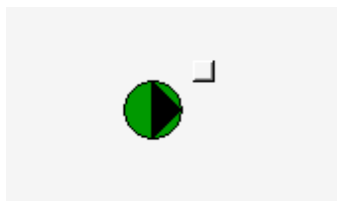
Pumpe (Bac_MOT01) ist eingeschaltet
