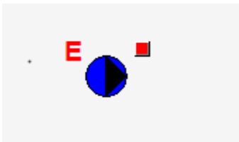
Pumpe (Bac_MOT01) mit unquittierter Störmeldung
