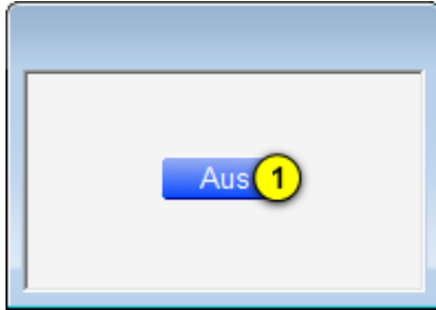
Prozessbild mit dem Objektsymbol des binären Eingangs (Bac_binary-input)
