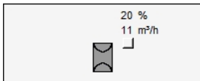
der Volumenstromregler (Bac_VAV01) hat keine Verbindung zur Steuerung
