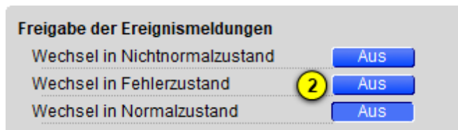
Teilbild der Konfiguration der Freigabe der Ereignismeldungen des Alarmbilds der Trenddatenaufzeichnung (Bac_trend-log)
