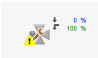
variabler Volumenstromregler (Bac_VAV21) mit Ausschaltung
