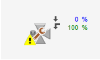
stetiges Ventil (Bac_VEN21) mit Ausschaltung
