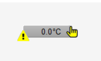
analoge Messung (Bac_MES01), welche mit einem Ersatzwert überschrieben wurde
