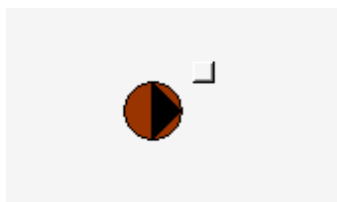
Pumpe (Bac_MOT01) ist ausser Betrieb
