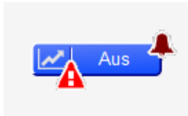
Trenddatenaufzeichnung (Bac_TRE21) mit quittierter Störmeldung
