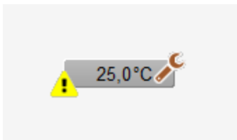
Sollwertschiebung (Bac_SOL02), welche ausser Betrieb (out-of-service) gesetzt wurde
