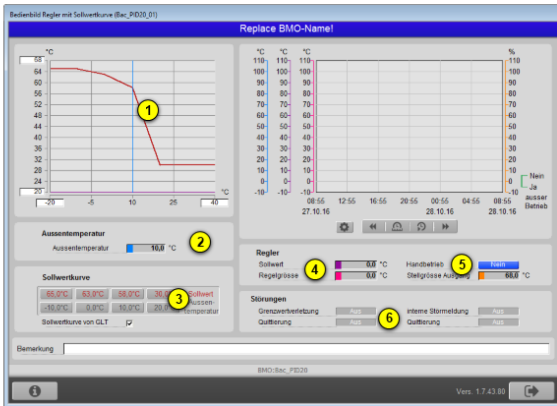
Bedienbild des Reglers mit Sollwertkurve (Bac_PID20)
