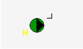
Pumpe (Bac_MOT01) ist von Hand betrieben
