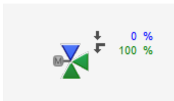
der variable Volumenstromregler (Bac_VAV21) ist geschlossen
