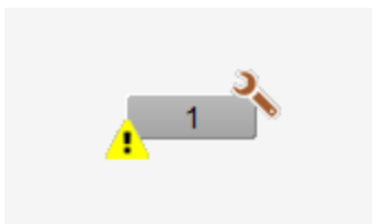
ganzzahliger Eingang (Bac_multi-state-input), welcher ausser Betrieb geschaltet wurde
