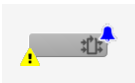
Steuerungsüberwachung (BacDevice) mit gehender Störmeldung
