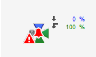
stetiges Ventil (Bac_VEN30) besitzt mit quittierter Störmeldung
