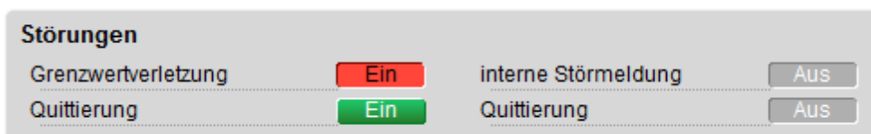
Anzeige einer kommenden Grenzwertverletzung eines analogen Werts (Bac_ANA21)
