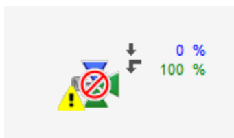
das stetige Ventil (Bac_VEN30) ist von Hand ausgeschaltet
