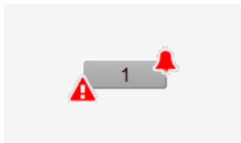
ganzzahliger Eingang (Bac_multi-state-input) mit kommender Störmeldung
