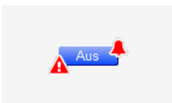
binärer Ausgang (Bac_binary-output) mit kommender Störmeldung
