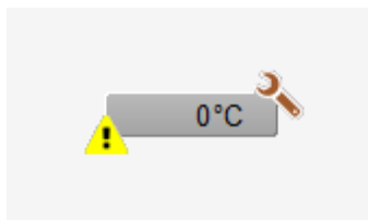
analoger Eingang (Bac_analog-input) mit einer Handschtung, jedoch ohne Störmeldung
