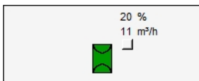
der Volumenstromregler (Bac_VAV01) ist geöffnet
