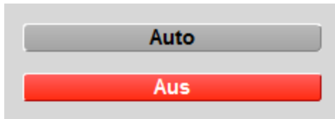
Ausschaltung des zw eistufigen Schaltbefehls (Bac_SWS22) mit Rückmeldung
