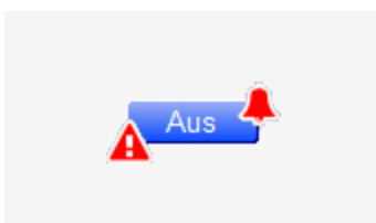
binärer Wert (Bac_binary-value) mit kommender Störmeldung
