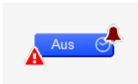
binäre Wochenschaltuhr (Bac_CLK21) mit einer anstehenden, quittierten Störmeldung
