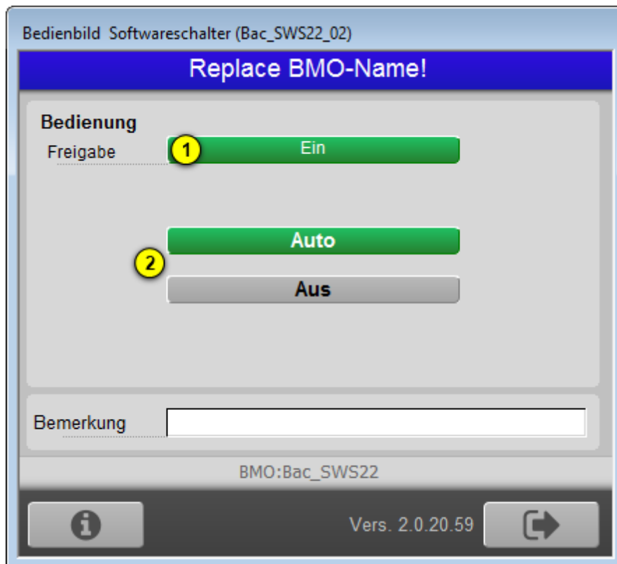
Bedienbild des zw eistufigen Schaltbefehls (Bac_SWS22)
