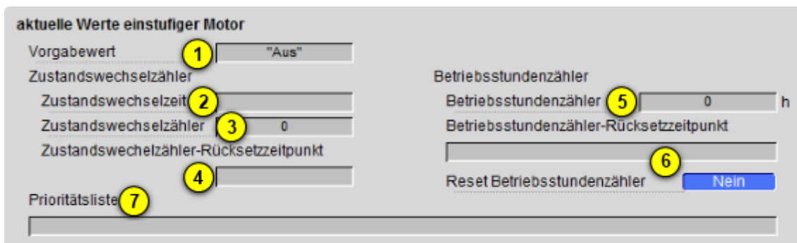
Betriebsinformationen des Infobilds der Pumpe oder des Ventilators (Bac_MOT21)
