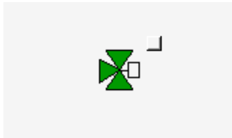
Die Stellklappe (Bac_VEN02, Dreiw egventil) ohne Rückmeldung
