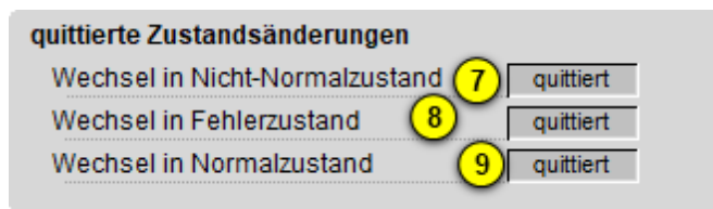
Abschnitt der Anzeige der quittierte Ereignismeldungen des Alarmbilds des Reglerobjekts (Bac_loop)
