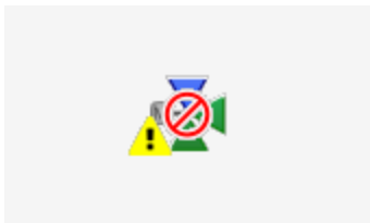
auf/ zu Ventil (Bac_VEN22) von Hand geschlossen
