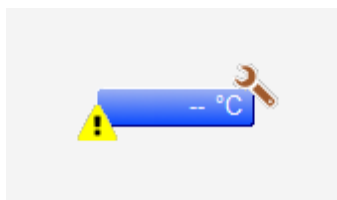
Sollwertanzeige des Reglerobjekts (Bac_loop) in Ausschaltung
