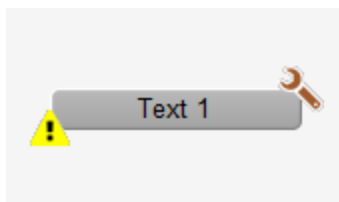
ganzzahliger Ausgang (Bac_multi-state-output), welcher ausser Betrieb geschaltet wurde
