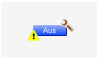
binärer Eingang (Bac_binary-input) welcher ausser Betrieb geschaltet wurde
