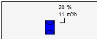
der Volumenstromregler (Bac_VAV01) ist geschlossen
