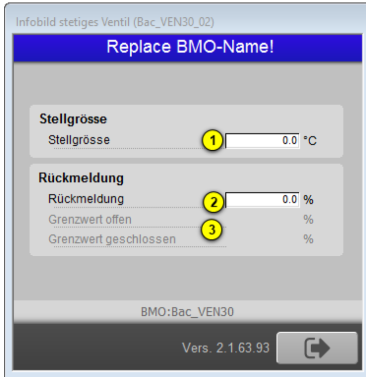
Infobild der stetigen Klappe oder des stetigen Ventils mit analoger Rückmeldung (Bac_VEN30)
