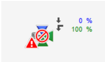
variabler Volumenstromregler (Bac_VAV21) mit Ausschaltung und Störmeldung
