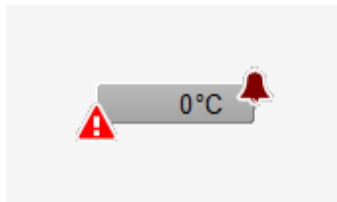
analoger Eingang (Bac_analog-input) mit einer quitierten Störmeldung
