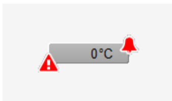
analoger Eingang (Bac_analog-input) mit einer kommenden Störmeldung
