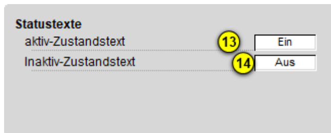
Konfiguration der Zustandstexte im Infobild der binären Trenddatenaufzeichnung (Bac_trend-log, Ausschnitt)
