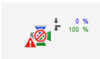
stetiges Ventil (Bac_VEN21) mit Ausschaltung und Störmeldung
