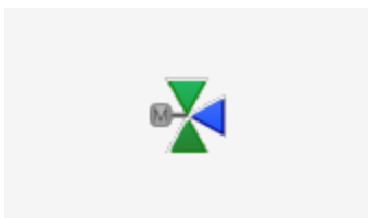
auf/ zu Ventil (Bac_VEN22) ist vollständig geöffnet
