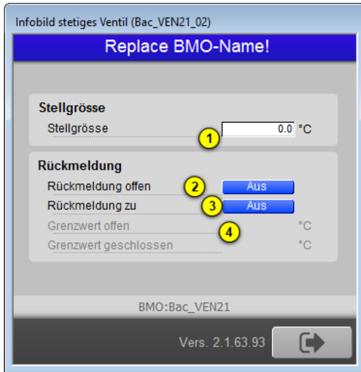
Infobild der stetigen Klappe oder des stetigen Ventils mit binärer Rückmeldung (Bac_VEN21)
