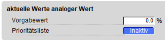
analoger Wert (Bac_analog-value) mit deaktivierter Prioritätsliste
