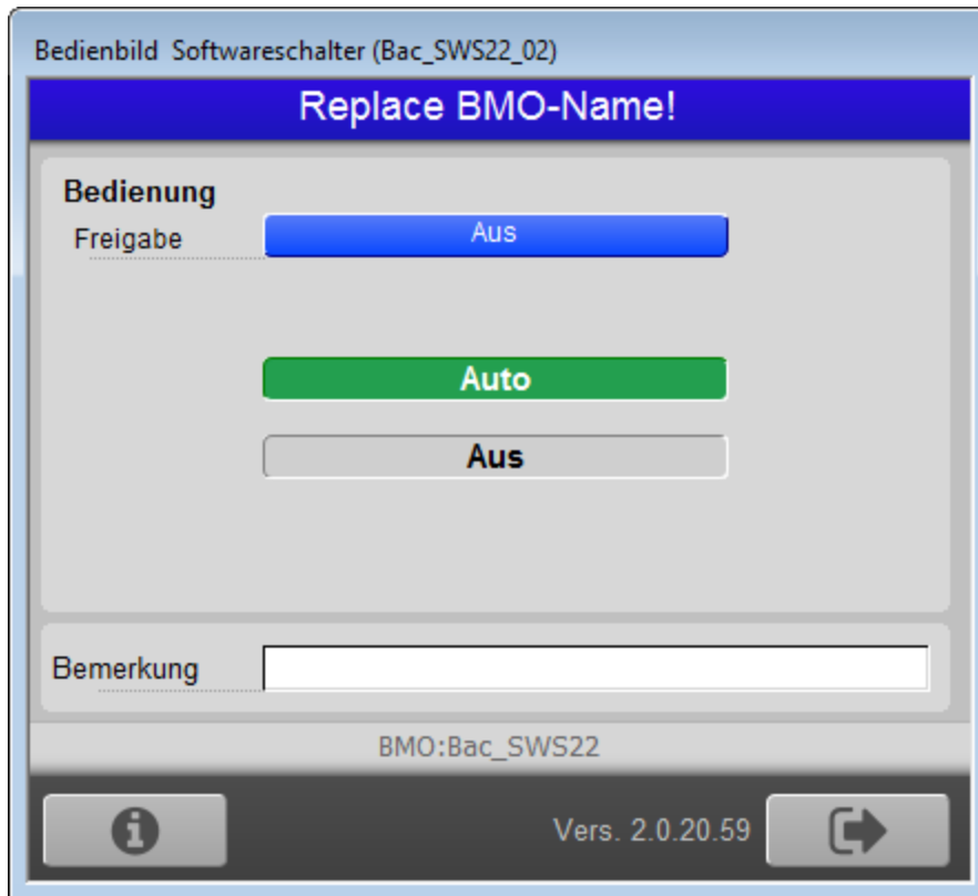
Bedienbild des zw eistufigen Schaltbefehls (Bac_SWS22) ohne Freigabe
