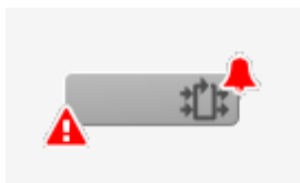
Steuerungsüberwachung (BacDevice) mit kommender Störmeldung
