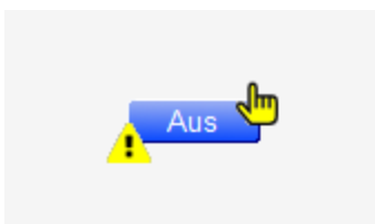
binärer Ausgang (Bac_binary-output), dessen Wert von Hand übersteuert wurde
