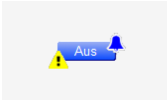
binärer Ausgang (Bac_binary-output) mit einer gehenden Störmeldung
