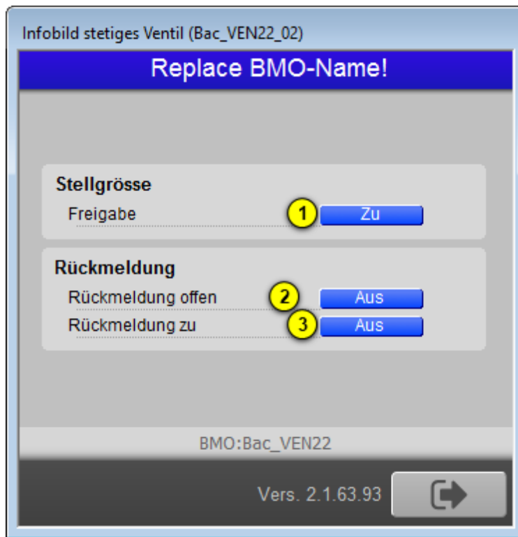
Infobild der auf/ zu Klappe oder des auf/ zu Ventils mit binärer Rückmeldung (Bac_VEN22)
