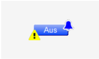
binärer Eingang (Bac_MEL21) mit einer gehenden Störmeldung
