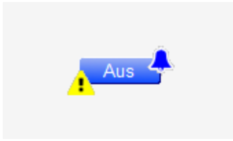
binärer Eingang (Bac_binary-input) mit einer gehenden Störmeldung
